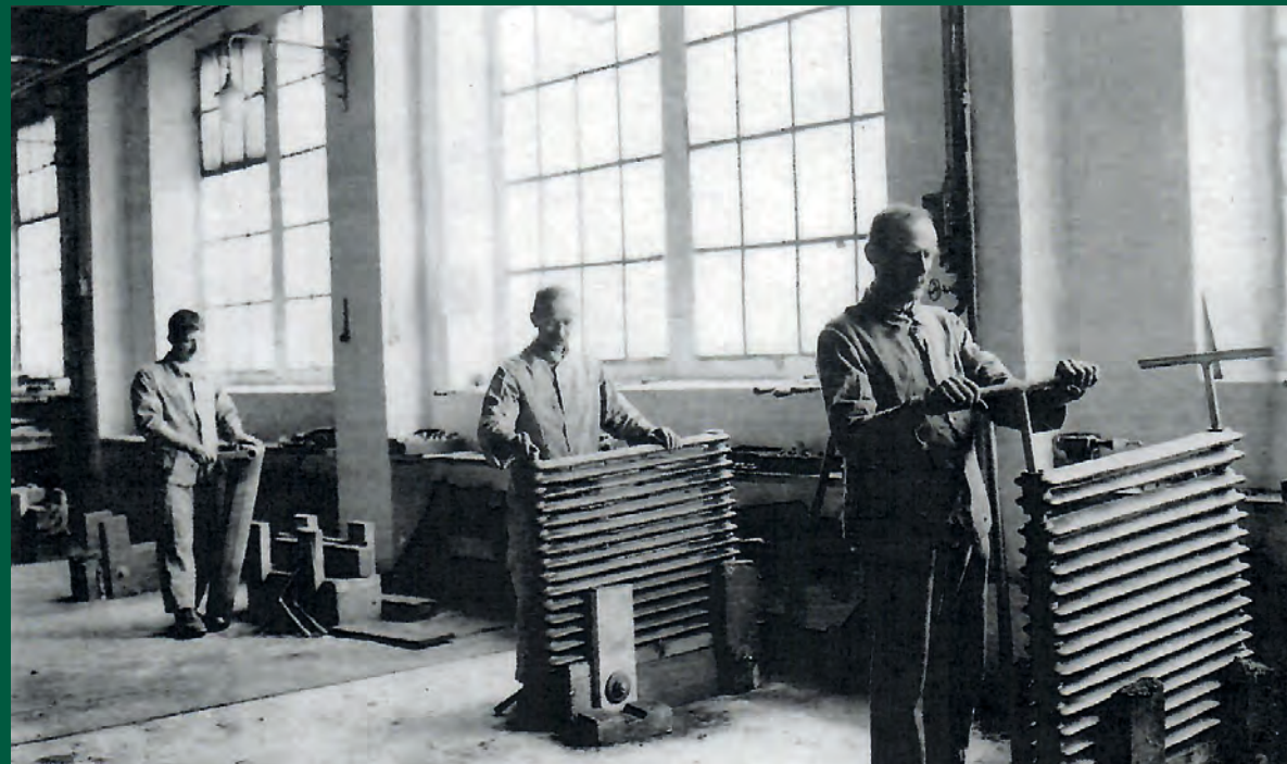
Heizkörpermontage in der Radiatorenfabrik des Eisenwerks, um 1950
